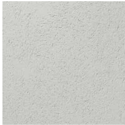
掻き落とし 材料塗り付け後、表面を掻き落としした贅沢な仕上げ。 塗込厚：10mm 仕上厚：8mm
