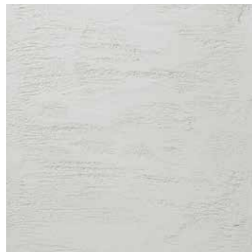
木ずり 木ゴテで横方向に模様付けした後に金ゴテで押さえた仕上げ。 仕上厚：5mm
