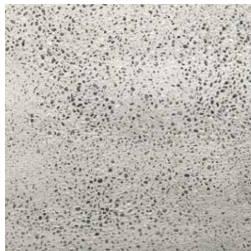
洗い出し 塗りつけ後、表面を洗い出した仕上げ。 ※大きめの骨材を混ぜ合わせて作ります。 仕上厚：10~15mm
