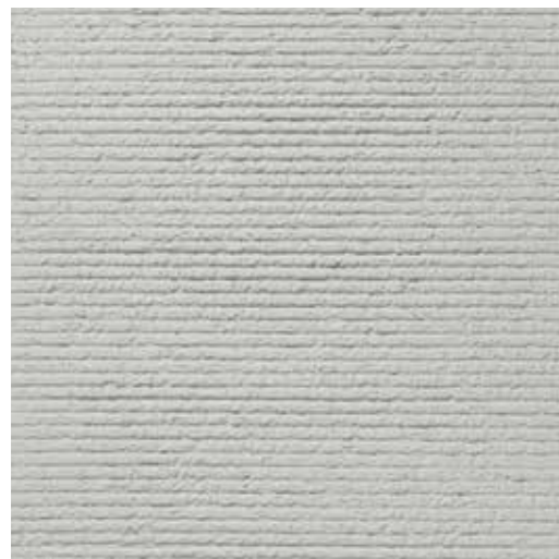
くし引きタロッシュ 材料塗り付け後、タロッシュで横引きに掻き落としした仕上げ。 塗込厚：10mm 仕上厚：8mm
